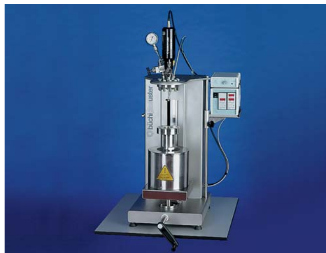
Hogedruk reactor Limbo Li van Büchi. Met lift en temperatuurregelaar. Max. 350 bar, 350°C.
